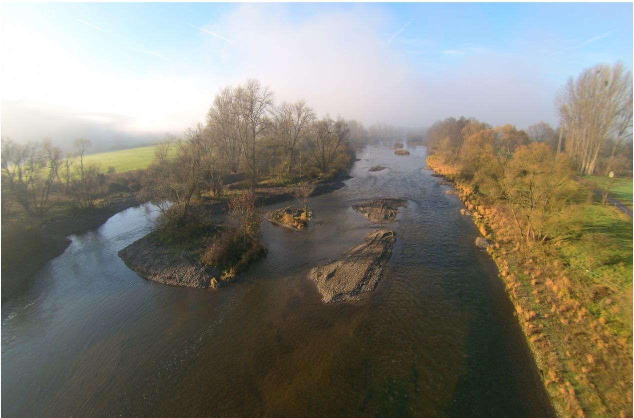
Abb. 5: Renaturierter Ederabschnitt mit Kiesbänken und –inseln und der hohen Breiten-, Strömungs- und Substratvarianz in der Gemeinde Edertal
